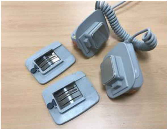
그림 9-5. 패들에서 성인용 전극을 분리하여 영아용 패들로 사용할 수 있다. 제조사에 따라 영아용 전극을 성인용 전극 앞에 붙여서 사용하는 제세동기도 있다.
